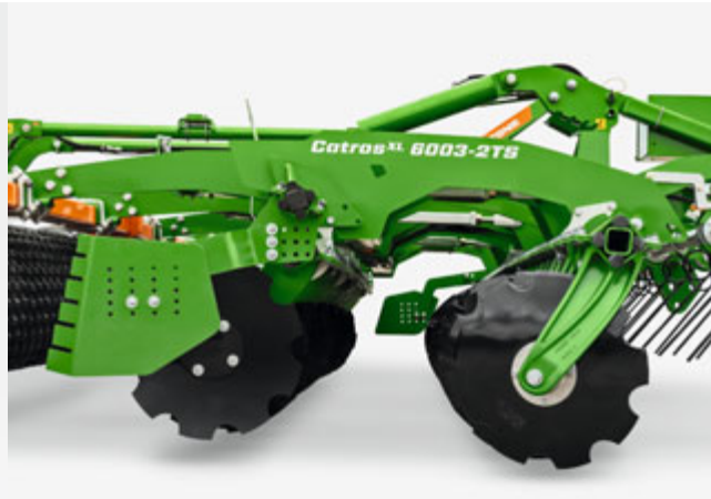
Catros XL 6003-2TS при наибольшей глубине обработки – диски полностью отведены в сторону от рамы
