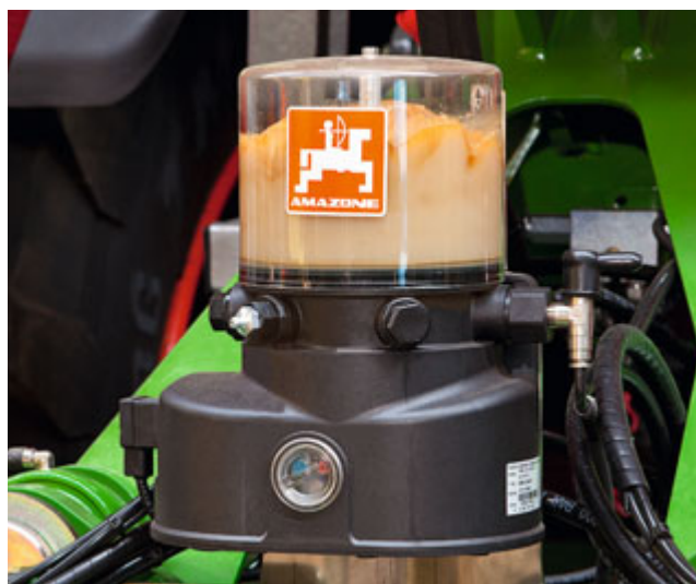
Насос с резервуаром для смазки
