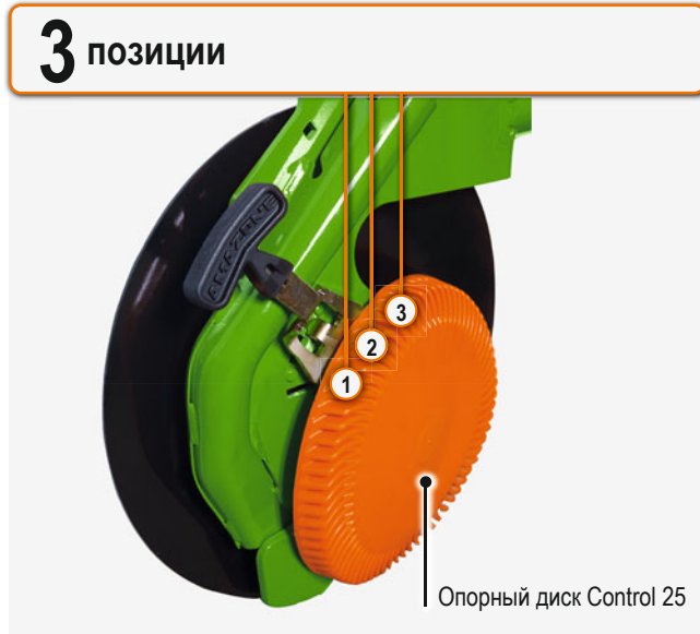
✓ Сошник RoTeC (Ø 320 мм) с опорным диском Control 25 Открытые ламели на тыльной стороне обеспечивают идеальную самоочистку.
