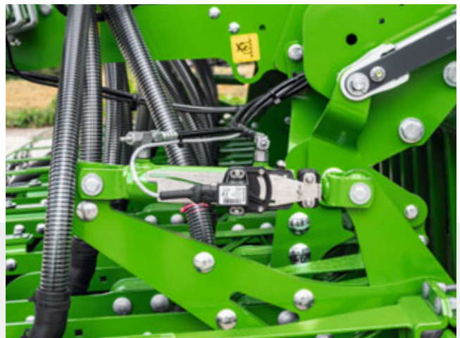
Цилиндр для гидравлической регулировки давления на сошник
