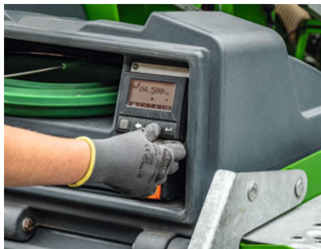
Опциональный терминал TwinTerminal 3.0 для ElectricDrive
