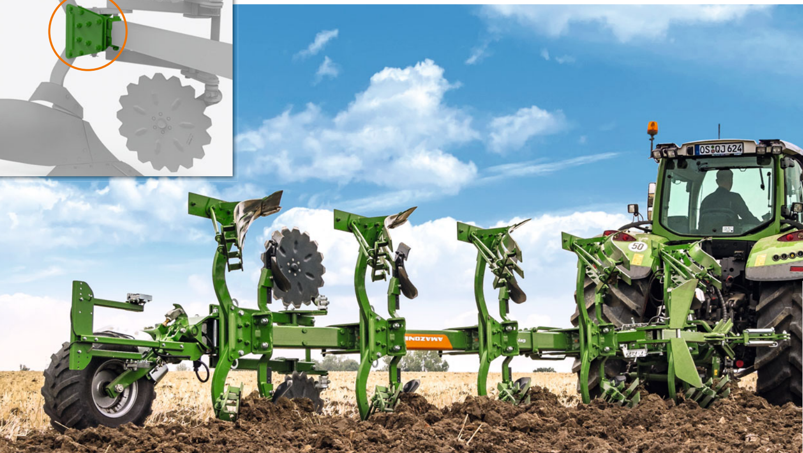
Предохранительный механизм в виде срезного болта
