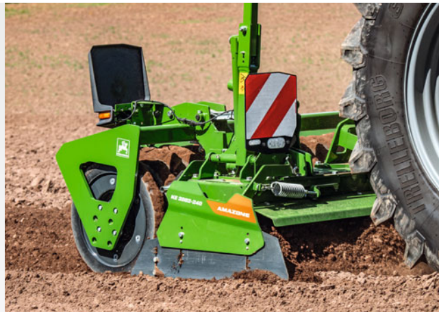
Ротационная борона KE 3002-240 Rotamix в виде соло-орудия
