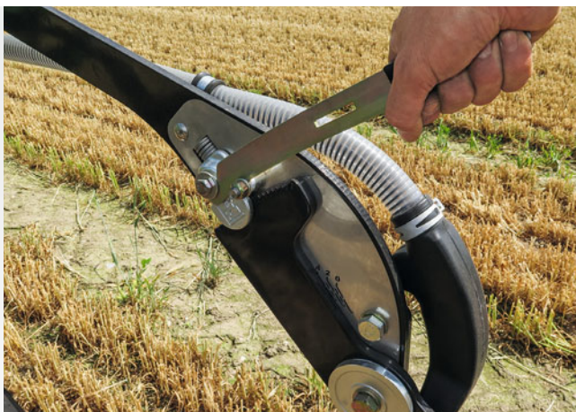
Регулировка долотовидного сошника по глубине
