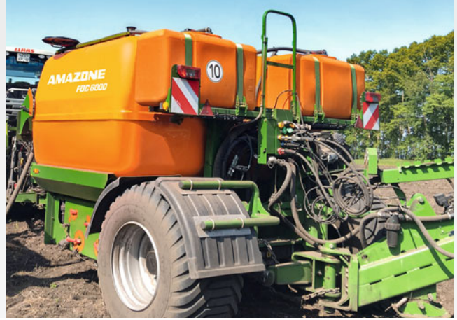
Два бака для чистой воды по 300 л
