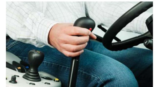
2 Кнопка сцепления на рычаге для простого переключения передач
