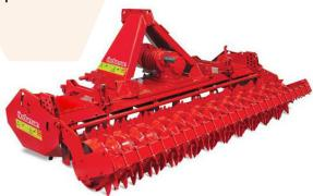
Механическая вертикальная фреза состоит из вращающихся ножей, параллельных земле, которые приводятся в действие от ВОМ трактора. Простая в эксплуатации фреза используется в основном для предпосевной подготовки почвы, измельчения стерни и различных растительных остатков.
