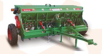
Комбинированная сеялка НВМ для зерновых культур – это посевная машина легкого прицепного типа, предназначена для рядового посева семян зерновых (пшеница, рожь, ячмень, овес), зернобобовых культур (горох, фасоль, соя, чечевица, бобы, чина, нут, люпин) с одновременным внесением минеральных удобрений.
