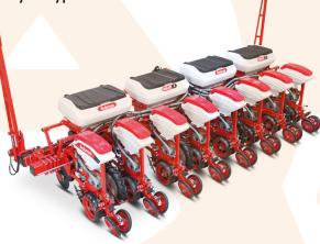
HVMD – дисковая сеялка точного высева, дисковый сошник, навесная, система контроля высева, гидравлические маркеры, с минеральными удобрениями и без.
