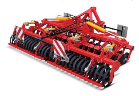
Компактные дисковые бороны подходят для обработки поверхностно и сильно перемешанной почвы. Особенность легкой тяги обеспечивает высокую скорость обработки, впечатляющую обработку почвы, а также низкий расход топлива. Изготавливается в виде фиксированного, складного и складного прицепного типа с шириной захвата от 2 до 6 метров.
