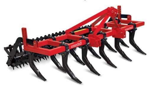
Чизельный плуг — это специализированное сельскохозяйственное оборудование для глубокой безотвальной вспашки почвы, осуществляющее дополнительное углубление пахотного горизонта. Эксплуатация чизельных агрегатов возможна с тракторами класса 3-4 т. и мощностью двигателя от 80 до 500 л.с..
