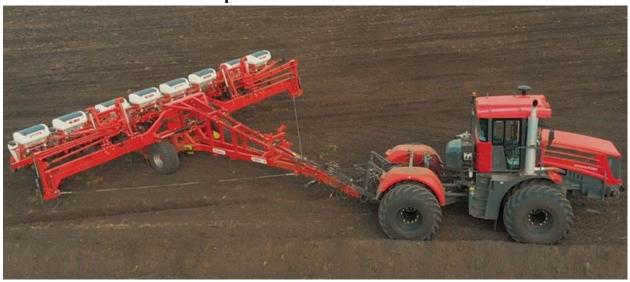
Модульная конструкция, состоящая из шасси с навешанными на него сеялками, обеспечивает хорошую маневренность как при посеве, так и в транспортном положении. Также данная особенность позволяет снять навешенные 8-ми рядные сеялки с шасси и, при необходимости, установить три четырехметровых, зерновых сеялки. производитель: Ozduman.
