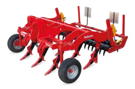
Глубокорыхлитель Ozduman IBP – это навесная машина, для обработки земли на глубину до 65 сантиметров без поднятия неплодородной почвы, данный глубокорыхлитель работает полностью с перекрытием рядов и не оставляет не обработанных участков почвы. IBP изготовлен совместно с Итальянскими проектировщиками и соответствует всем необходимым Европейским нормам и стандартам.
