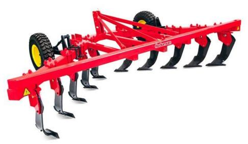
Глубокорыхлитель французского типа, благодаря структуре лап не оставляет необработанных участков между рабочими органами, разбивает нижний жесткий слой (подошву) и не поднимает на поверхность неплодородную часть почвы.
