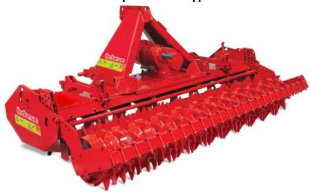
Механическая вертикальная фреза состоит из вращающихся ножей, параллельных земле, которые приводятся в действие от ВОМ трактора. Простая в эксплуатации фреза используется в основном для предпосевной подготовки почвы, измельчения стерни и различных растительных остатков.
