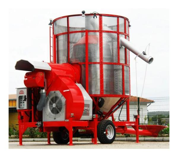
Мобильная зерносушилка Ozsu TKM - передвижная сушилка турецкого производства циклического действия, предназначенная для сушки всех видов зерновых и зернобобовых культур.
