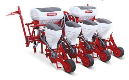
HVM - сеялка точного высева, анкерный сошник для семян, доступна навесная и прицепная версия, анкерный сошник для удобрений, многофункциональная система контроля высева, гидравлические маркеры.
