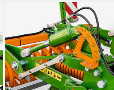
Гидравлическая регулировка глубины обработки с четкой шкалой
