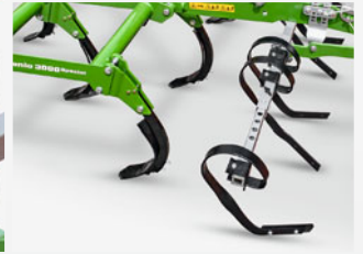
Пружинные выравниватели – для простой настройки
