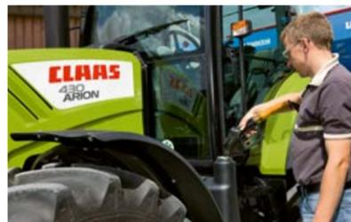
Большой бак для горючего ARION 400 минимизирует время заправки, а следовательно, и простоя. Со 175 л вместимости он позволяет длительно и продуктивно работать.
